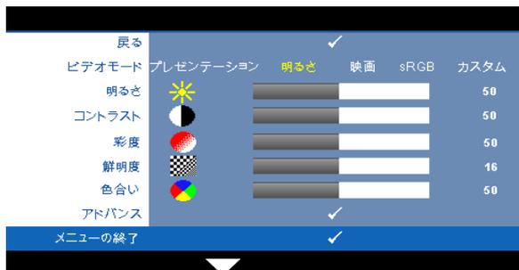
**ビデオモード**—ディスプレイの画像を最適化します：**プレゼンテーション**、**明るさ**、**映画**、**sRGB** (より精密な色を提供します)、**カスタム** (お好みの設定を設定します)。明るさ、**コントラスト**、**彩度**、**鮮明度**、**色合い**、**アドバンス**に対して設定を調整すると、プロジェクタは**カスタム**に自動的に切り替わります。
