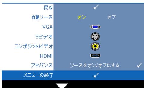
**自動ソース** — オフ (デフォルト) を選択して、現在の入力信号をロックします。**自動ソースモード**を**オフ**に設定した状態で**ソース**ボタンを押すと、入力信号を手動で選択できます。**オン**を選択すると、使用可能な入力信号を自動検出します。プロジェクトの電源が入った状態で**ソース**ボタンを押すと、次の使用可能な入力信号を自動検出します。
