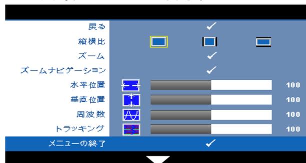
**縦横比**—アスペクト比を選択して画像の表示方法を調整します。
