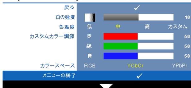
**白の強度**—とを使ってディスプレイの白の強度を調整します。
