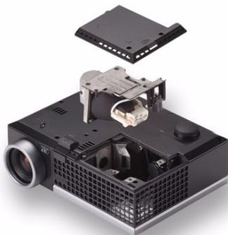
9 OSD ランプタブにあるランプリセットで「はい」を選択して、ランプ使用時間をリセットします ( ページ 33 の [ ランプ ] メニューを参照してください)。新しいランプモジュールを変更すると、プロジェクタはランプ時間を自動的に検出しリセットします。
