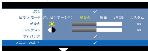
**ビデオモード**—ディスプレイの画像を最適化します：**プレゼンテーション**、**明るさ**、**映画**、**sRGB**（より精密な色を提供します）、**カスタム**（お好みの設定を設定します）。**明るさ**、**コントラスト**、**彩度**、**鮮明度**、**色合い**、**アドバンス**に対して設定を調整すると、プロジェクタは**カスタム**に自動的に切り替わります。
