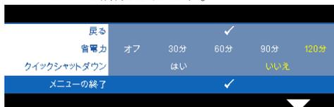
**省電力** — オフを選択すると省電力モードは無効になります。デフォルトで、プロジェクタは 120 秒間動作しないと省電力モードに入ります。画面に、60 秒間のカウントダウンの後、省電力モードに切り替わるという警告メッセージが表示されます。カウントダウンの間にどれかのボタンを押すと、省電力モードは停止します。
